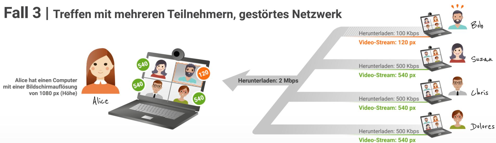
Die von Suzan, Chris und Dolores verwendete Upload-Bandbreite beträgt jeweils 500 Kbps. Dies ermöglicht die Übertragung eines Videostroms von 540 Pixel für jeden.
